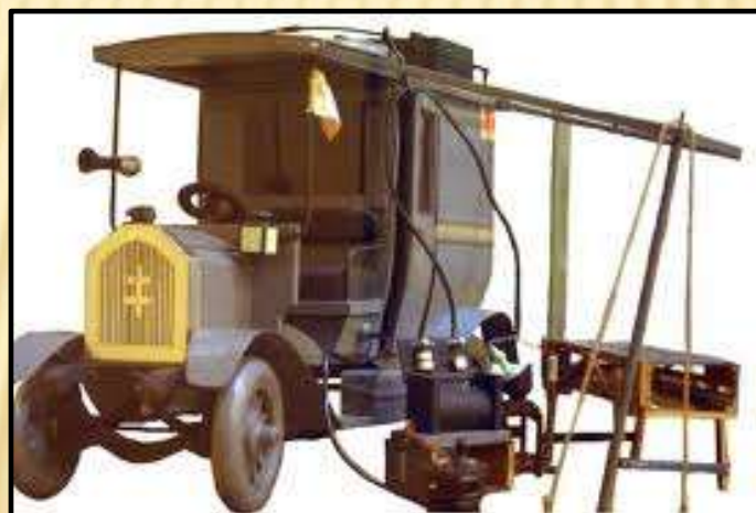
L'auto-chir Modèle réduit de la voiture radiologique de 1914-1918, type Massiot-Philips (Coll. Musée du Val de Grâce)
