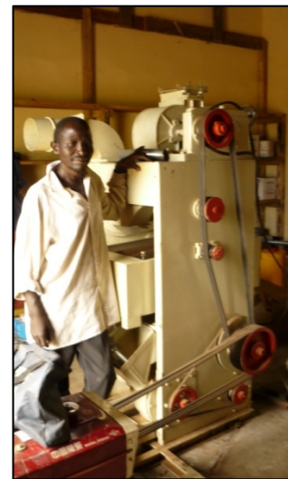
Photo 33. Décortiqueuse récemment installée à Vinza
