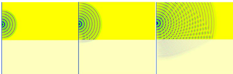
Figure 22. Illustration de la propagation (en 2D, coupe verticale en conditions homogènes) des fronts d'ondes issues d'une source ponctuelle monochromatique monopolaire et immobile en présence d'un sol absorbant (à gauche) au temps t , (au centre) au temps t+\Delta t et (à droite) au temps t+n\cdot\Delta t [open applet Ripple Tank v1.7e]
