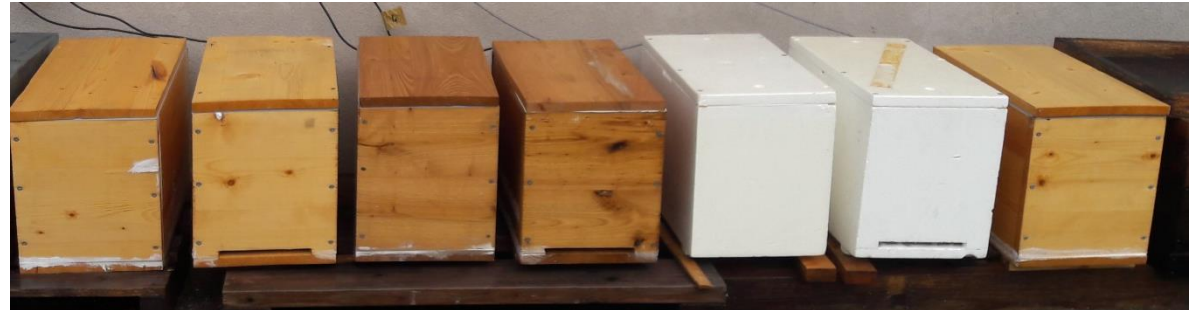
Ruches en polystyrène et châtaigner instrumentées de capteurs hygrothermiques
