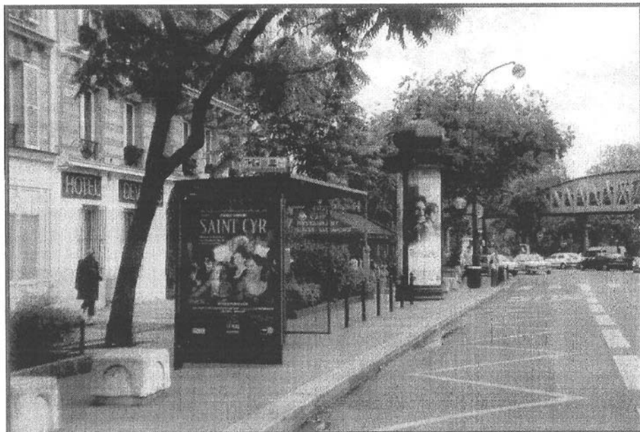
(Ligne 91. Arrêt St Marcel- La Pitié) Potelets de défense anti- stationnement et aménagement de qualité
