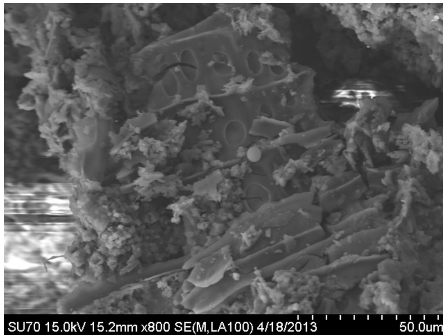
Fig. 2. Échantillon 4 : aurochs noir du Diverticule. Image SEM. Fragment de charbon de bois pouvant être identifié comme appartenant au genre Pinus. Les ponctuations fenestrées arrondies évoquent Pinus nigra. Sample 4: black aurochs of the Diverticule. SEM image. Fragment of charcoal identified as belonging to genus Pinus. The rounded fenestrated punctuations could be compared to Pinus nigra.
