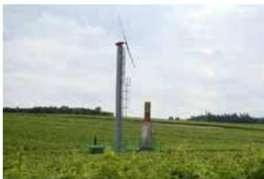
Associées ou non à un système de chauffage, elles permettent de brasser l'air un peu moins froid des couches supérieures et limite la perte de chaleur par rayonnement (gelées blanches).
