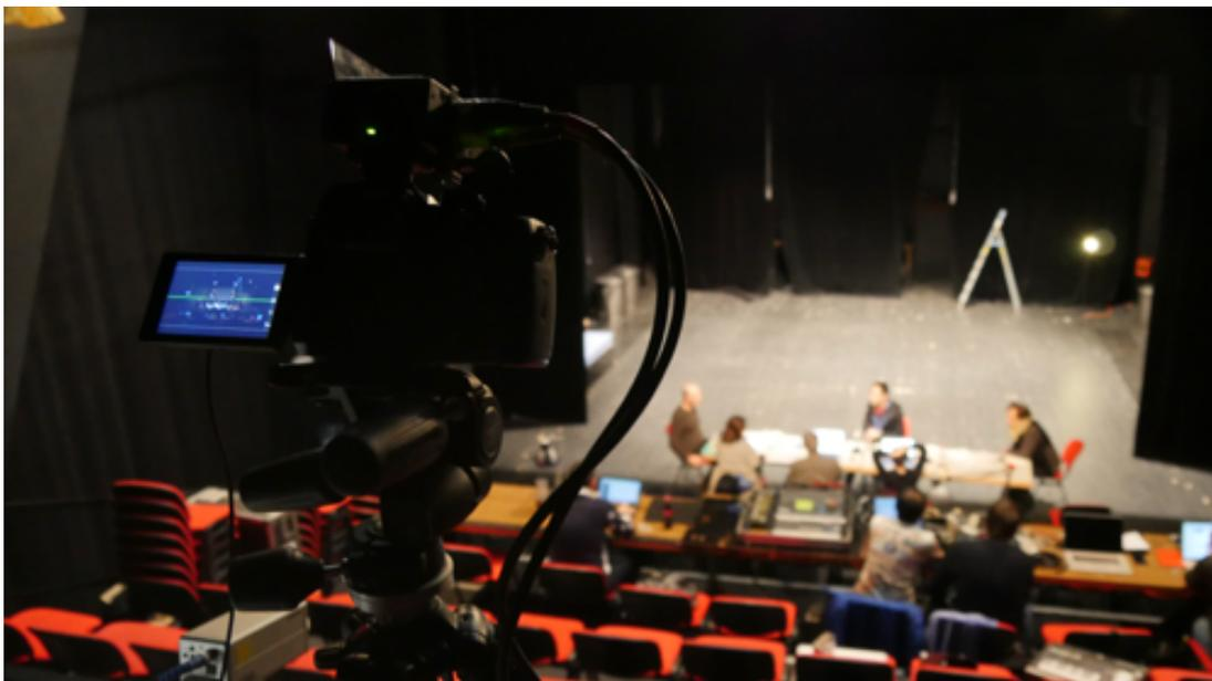
Figure 1 : Le système de prise de vues KinoAI est constitué d'un simple appareil photo placé au fond de la salle.
