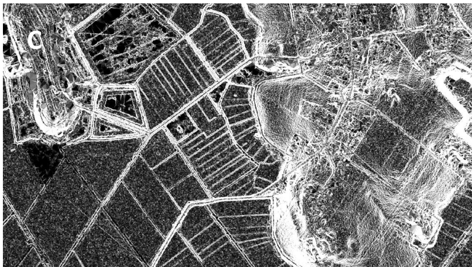
Figure 5 Exemple de Type 2 : détection d'un ancien réseau de canaux anthropisés. Secteur : La Guesne (Crosac), rue des Marais. A : BD ORTHO 2018 / B : Litto3D 2011 / C : Raster de Pente.
