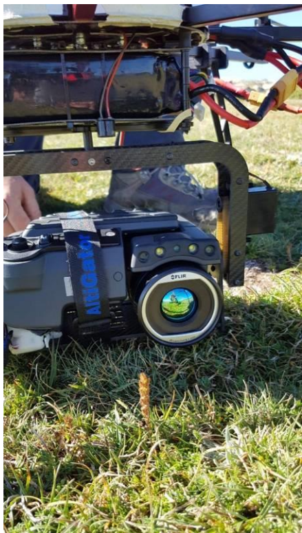
Figure 30 - Drone octorotor équipé d'une caméra thermique Flir T620 – (Photo. C. Calastrenc)
