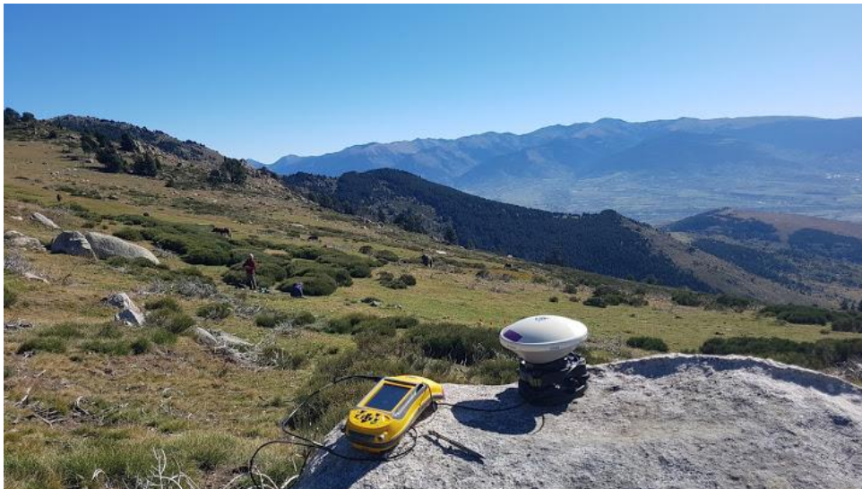
Figure 27 - Base DGPS (Trimble GeoXH3000 Série) – (Photo. C. Calastrenc)
