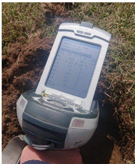
Figure 33 - XRF Nitron XL3t-980 du plateau P2P du laboratoire GEODE (UMR 5602)
