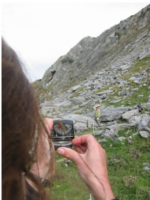
Figure 10 - Relevé à la boussole (Estive d'Anéou - Photo C. Calastrenc)
