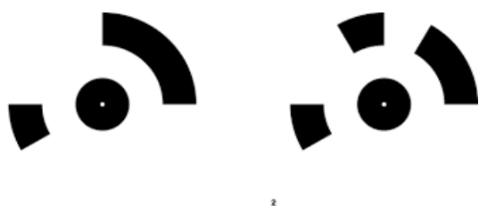
Figure 72 - Exemple de cible codée Photoscan
