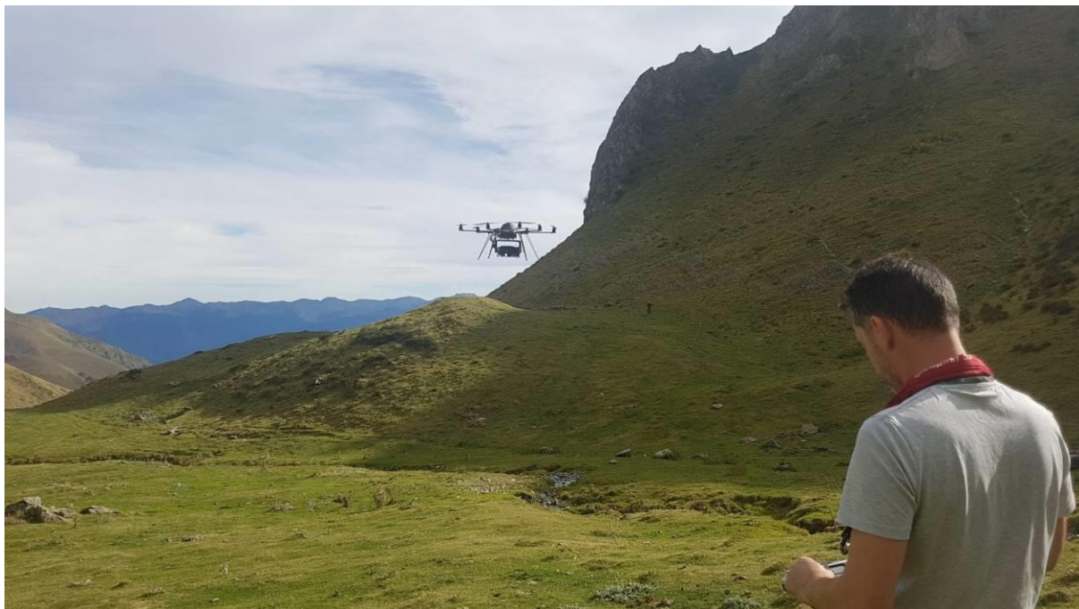
Figure 28 - Drone octorotor équipé d'un appareil photographique numérique Canon G1X – (Photo. C. Calastrenc)
