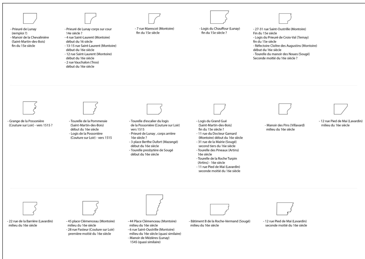
Figure 38 : Schéma des différentes formes de corniches repérées
