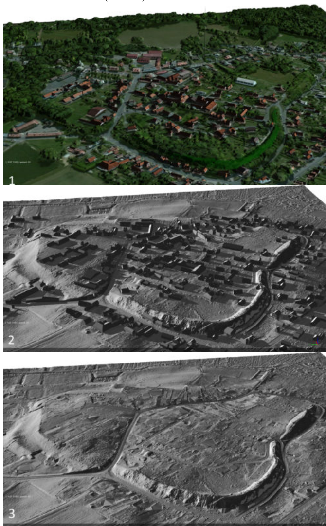
Figure 1 : respectivement de 1 à 3: modélisation exhaustive, modèle numérique d'élévation et bâtiment B.I.M, modèle numérique de terrain avec présence de fortifications inconnues à ce jour.
