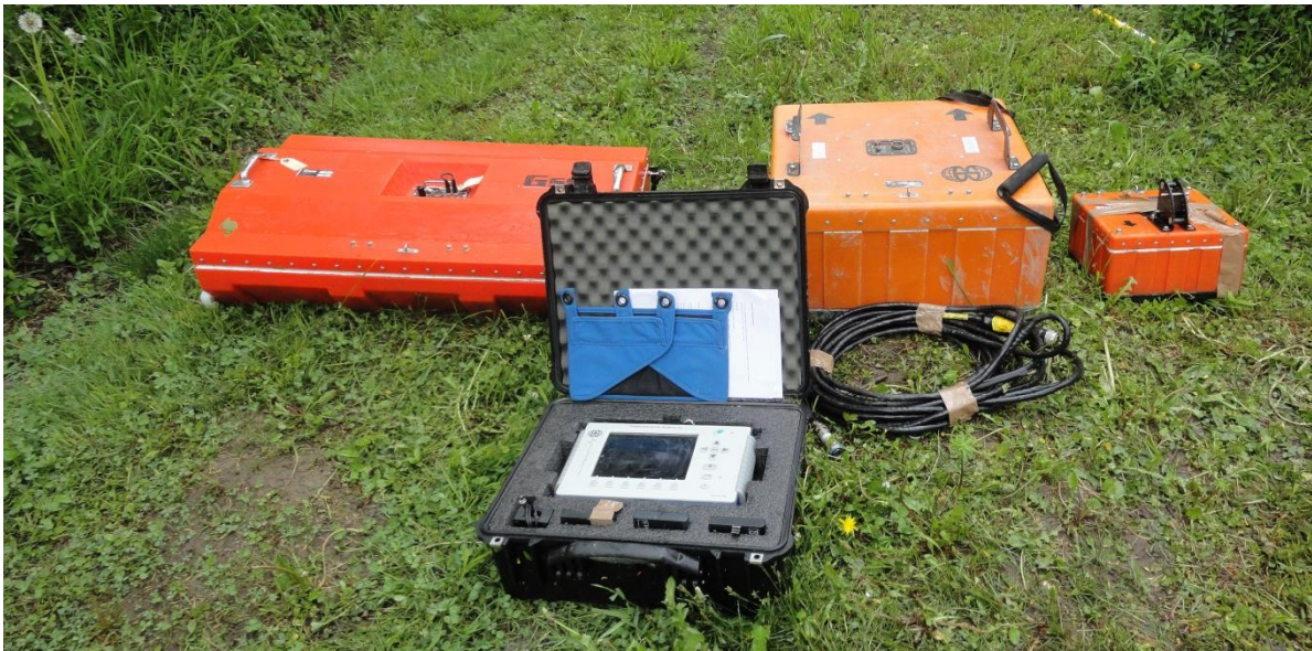
Figure 9 : le SIR-3000 au premier plan, et de gauche à droite les antennes de 100, 200 et 400 Mhz
