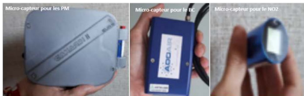
Figure 2 : Dispositif des micro-capteurs déployés pour le recueil de données dans les cohortes VGP et RECORD (Polluscope)
