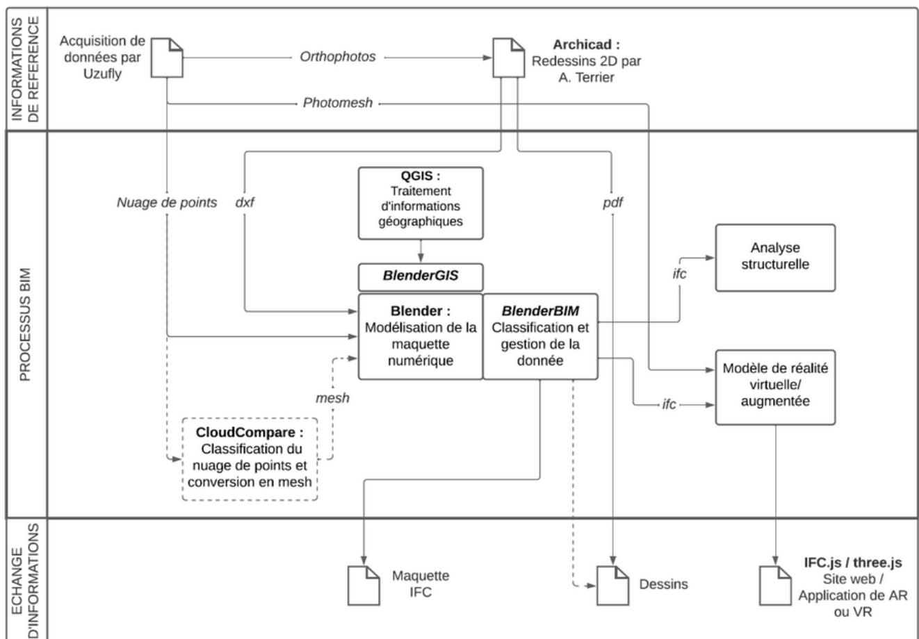
Fig. 5 : Schéma du processus BIM (©R. Vouilloz – EPFL)
