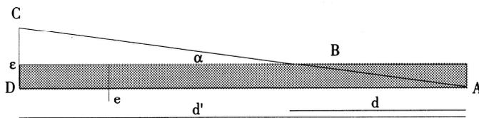
La déviation maximale apparaît lorsque  $A$  et  $B$  sont sur deux côtés opposés du trait. La demi-erreur angulaire est  $\alpha$ . On peut en déduire l'erreur métrique au niveau du point de fuite  $C$ . L'erreur métrique  $\varepsilon$  est égale à la longueur du segment  $CD$ . Les erreurs angulaire et métrique peuvent être calculées à partir des paramètres de reconstruction :
