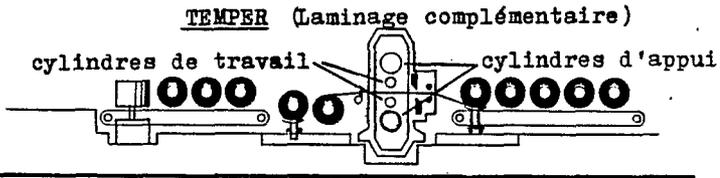
Le TEMPER est réalisé par une cage de lamination. C'est une légère réduction d'épaisseur, qui durcit la surface et permet d'obtenir de bonnes caractéristiques mécaniques.
