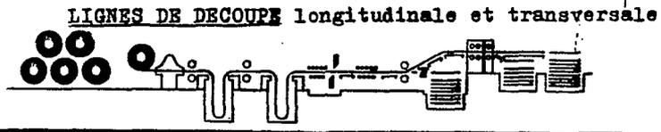
Les bobines peuvent également être découpées, si le client le désire, en feuilles d'acier (découpe transversale) ou en rubans (découpe longitudinale). C'est le cas pour environ 20% de la production.
