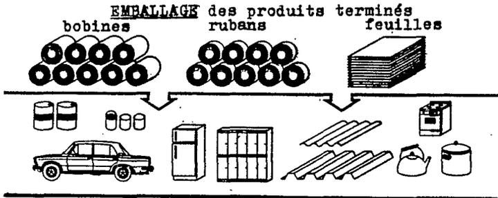
Sous forme de bobines, feuilles ou rubans, le matériau est emballé dans du papier, généralement renforcé de métal. L'emballage est la ligne la moins mécanisée.
