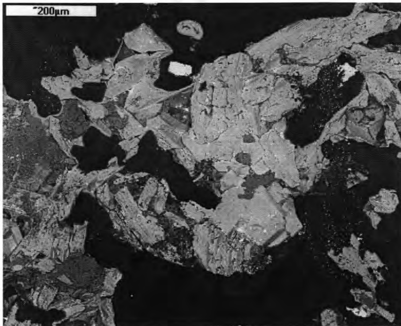
Fig. 7 Microstructures d'un objet en "bleu égyptien" massif (les grains gris plus sombres sont des grains de quartz, les grains gris clairs des cristaux de cuprorivaite; les grains blancs sont des restes de cuivre); cliché MEB.
