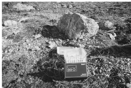
Photo 3 – Centrale d'acquisition Grant Squirrel et microsondes thermiques (28 juin 2002).
