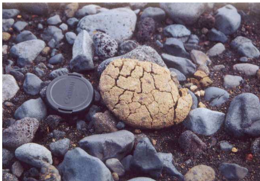
Figure 2 : sensibilité des hyaloclastites à la gélifraction, insensibilité des basaltes après 4 années d'exposition à la météorisation.
