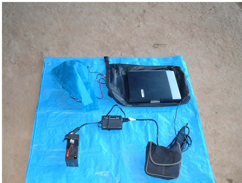
Figure 4 : ensemble de rechargement solaire pour les équipements de terrain
