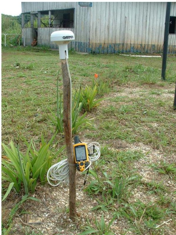
Figure 2 : système GPS utilisé lors des missions de terrain.
