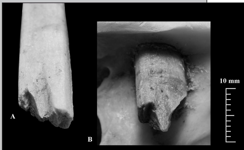
Fig. 124 : expérimentation 2004 - fracture des deux fourchons, à la base (tir au propulseur). La pointe de droite (B) est incrustée dans une vertèbre cervicale de l'animal cible.
