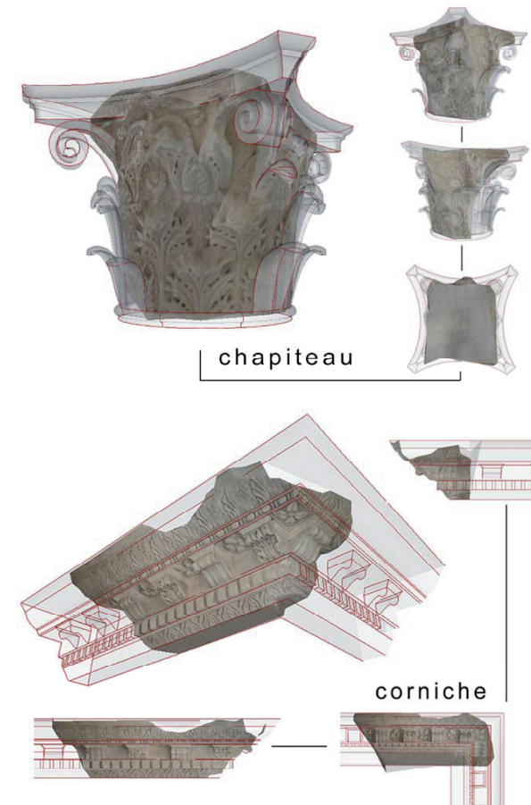
Fig. 7. Restitution 3D des éléments théoriques du bâtiment de scène à partir du relevé des fragments [aut. F. De Domenico, 2003]
