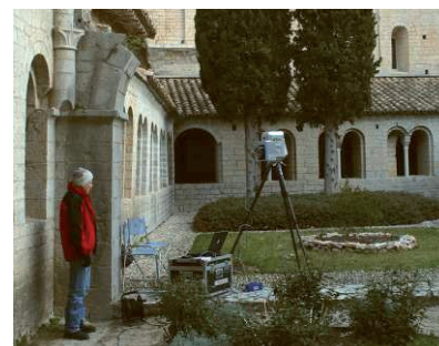
Fig. 6. Scan laser du cloître lors de la campagne de relevé de février 2006 [aut. L. De Luca, 2006]
