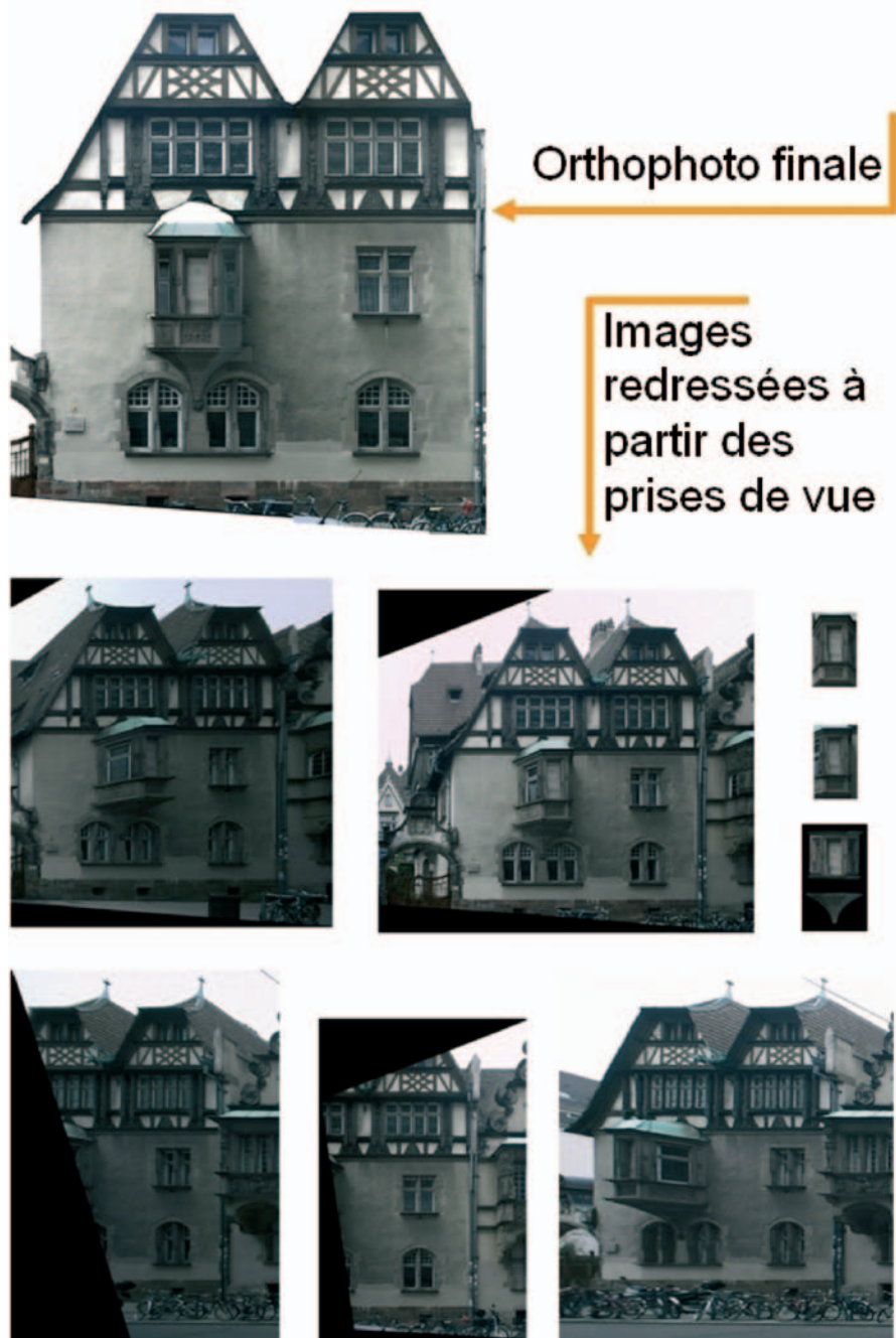
Figure 4. Orthophoto basée sur les images redressées
