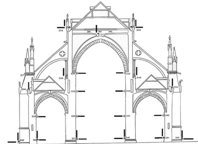
Figure 2 : coupe transversale et mouvements auscultés)
