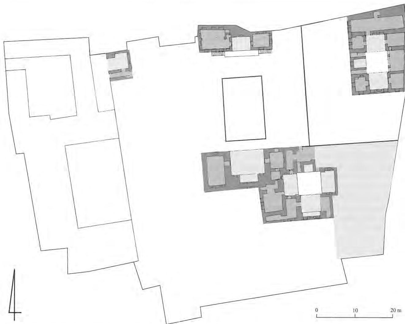
Fig. 3: Le palais Janbulad à Alep. Ne sont représentées ici que les parties anciennes du palais, la qa'a mamelouke réaménagée et l' iwan (vers 1550), le petit iwan au nord (avec le grand bassin entre les deux iwans ), la grande qa'a du haram (XVII e siècle) dans l'angle nord-est, l'ancienne entrée au nord-ouest. Aux XVIII e et XIX e siècles, une partie des jardins a été occupée par des bâtiments dans une logique d'organisation de cours (Relevé et dessin J. C. David, T. Grandin, M. O. Rousset)
