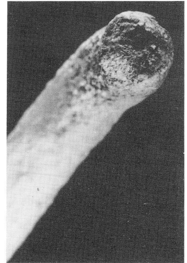
FIG. 41. — N° 1, ST 5. Vue détaillée de l'effet de compression de la partie active.
