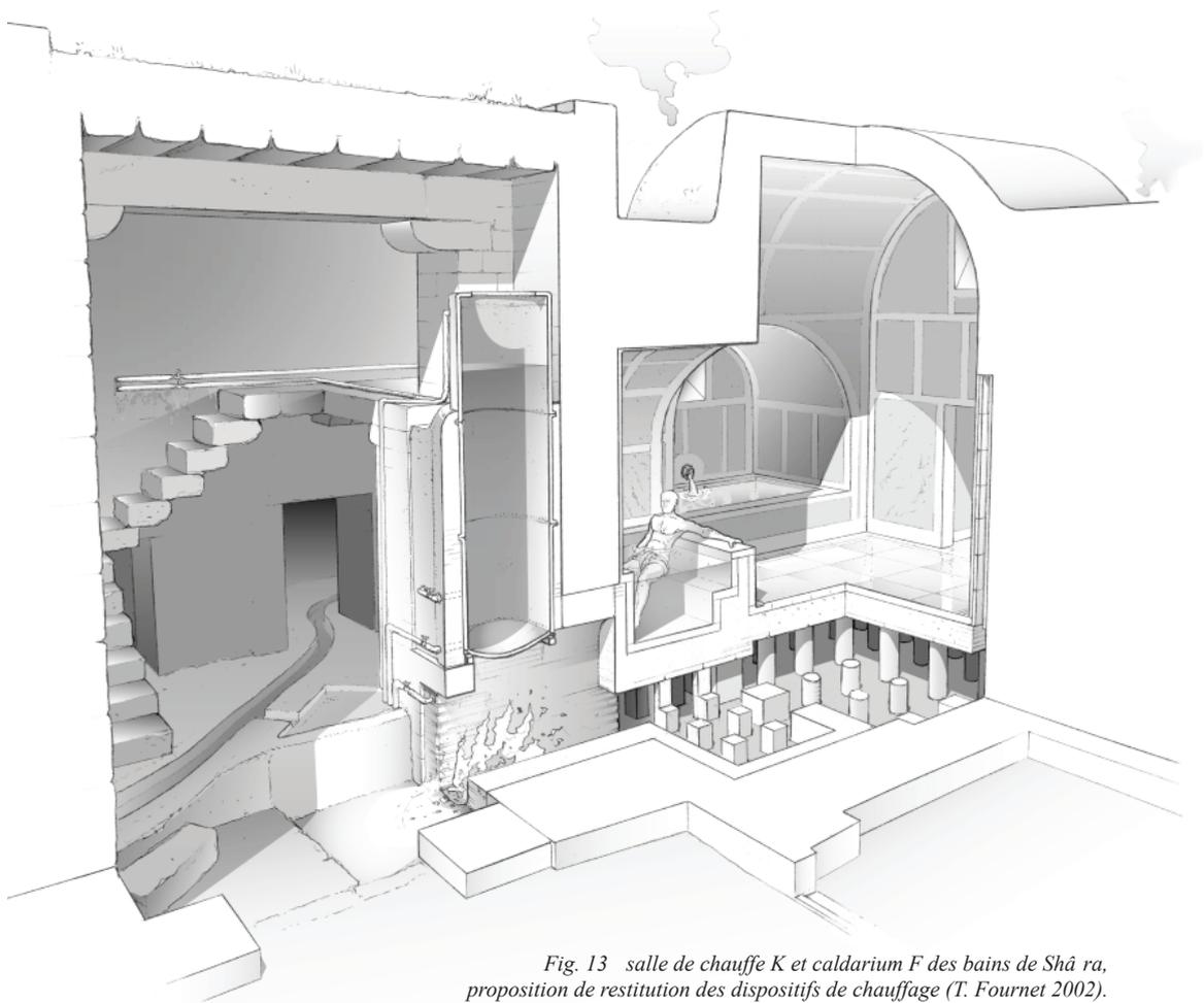
Fig. 13 salle de chauffe K et caldarium F des bains de Shâ-ra, proposition de restitution des dispositifs de chauffage (T. Fournet 2002).
