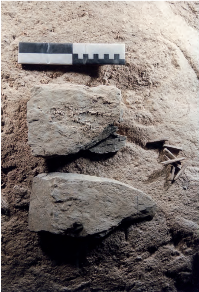
Fig. 112 : Schiste bleu et chevilles en chêne extraits des maçonneries du déambulatoire, début XIII e siècle. Cathédrale de Bayeux.
