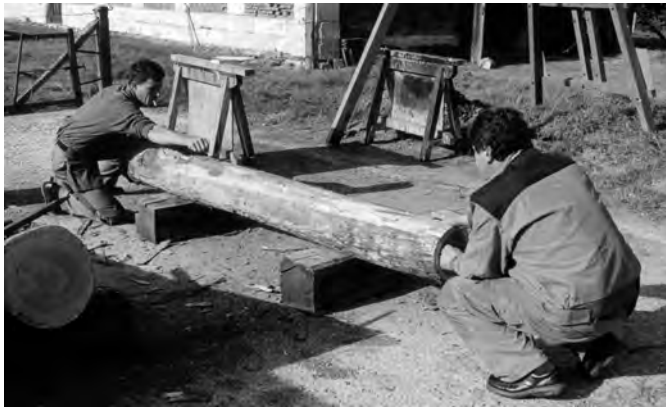
Fig. 33-3 : Le cordeau, imprégné d'une substance colorante, est pincé pour ligner le bois.
