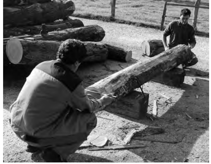
Fig. 33-2 : Les arêtes de la future pièce sont lignées au cordeau à partir des tracés précédents pour délimiter les faces à équarrir.
