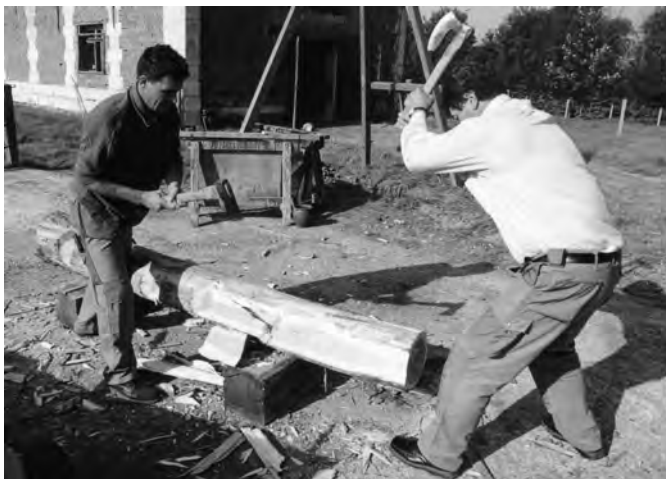
Fig. 33-5 : La face est équarrie suivant le trait, en retirant le bois laissé entre les encoches.
