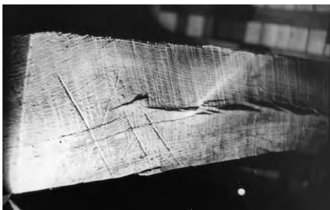
Fig. 40 : Face sciée marquée, déformée par le tirage au cœur, cathédrale de Bayeux, bras sud (1223-1226d).
