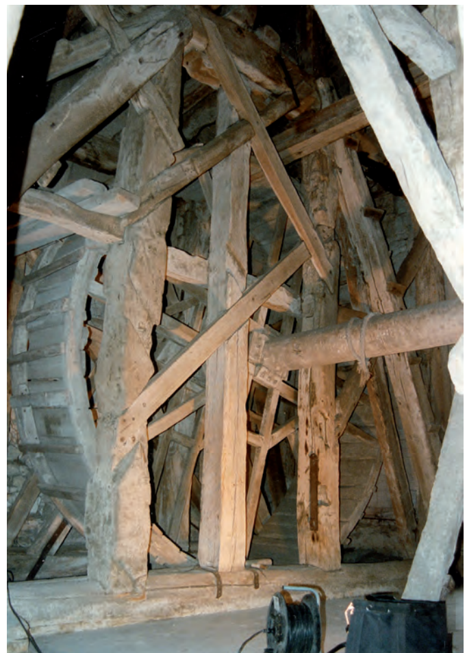
Fig. 99 : Roue à cage d'écureuil, fin du Moyen Âge. Cathédrale de Bayeux, tour nord.
