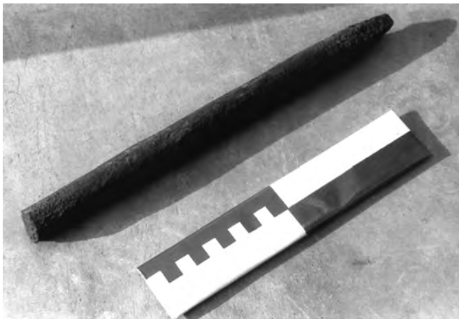
Fig. 109 : Cheville métallique, 1227-1232d. Cathédrale de Rouen, nef.
