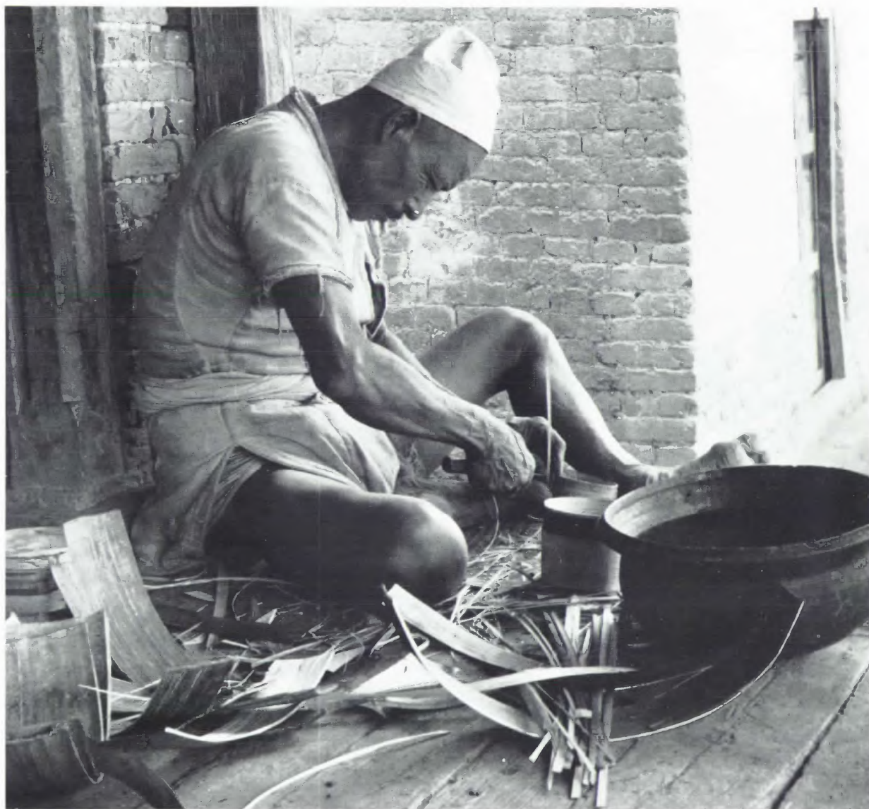
55. Fabrication de boîtes en bambou, pyāng : le vannier perce un trou avec son poinçon pour passer les lanières. On remarquera à droite le récipient en terre cuite, bhviēga , où l'on fait tremper les tiges de bambou avant de les utiliser.
