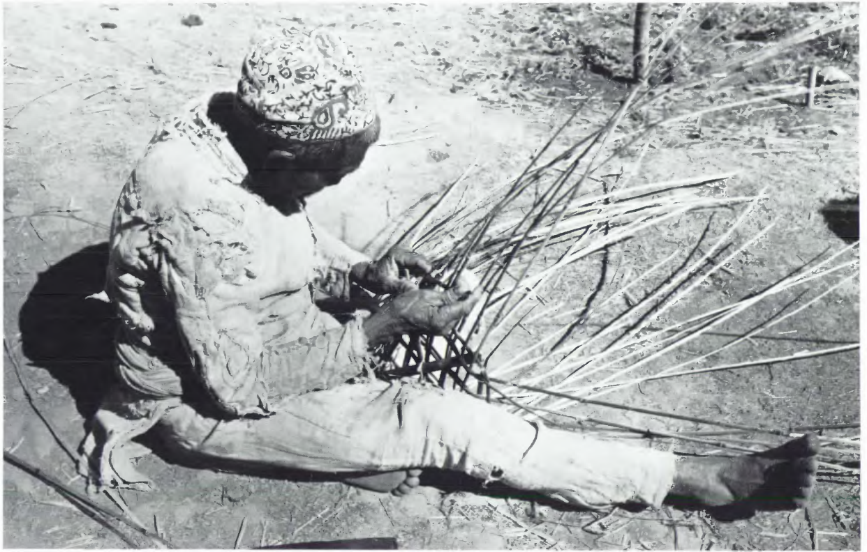
53. Fabrication d'une hotte, doko : le vannier fait monter les bords.
