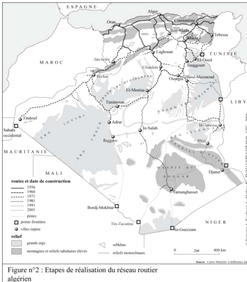
Figure n°2 : Etapes de réalisation du réseau routier algérien
