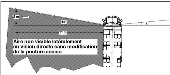
contraint de reculer son siège et de réduire par là même son champ de vision latérale. Il est alors pénalisé dans sa conduite routière, en particulier à l'entrée des rond-points avec priorité à gauche. Le schéma ci-dessous montre les effets sur la vue latérale de
