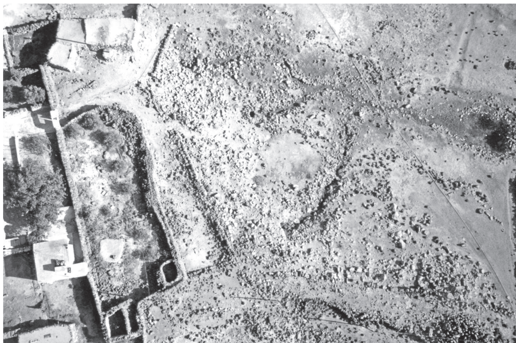
Fig. 6 - Sharaya, Tell est : captages de trois sources sous le rempart, réunies dans un seul canal.
