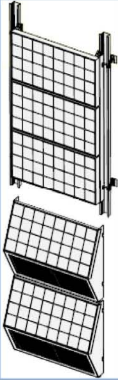
Bardage solaire vertical (haut) ou à redents (bas)
