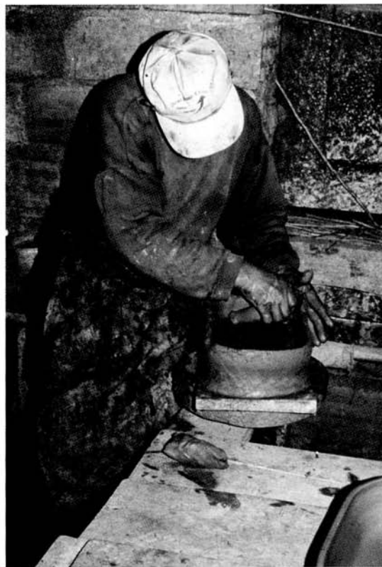
Figure 10 António Coimbra : montage de la paroi à l'aide de colombins (Cliché J. T.)
