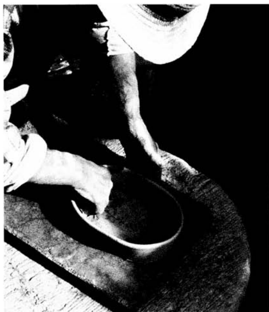
Figure 27 Joaquim Ribeiro Alvelos : finition du fond après mise en forme (Cliché J. T.)
