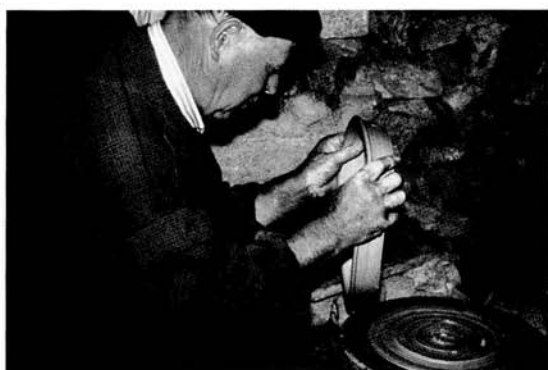
Figure 15 Luís da Silva prélève seul la paroi tournée pour son assemblage (Cliché J. T.)
