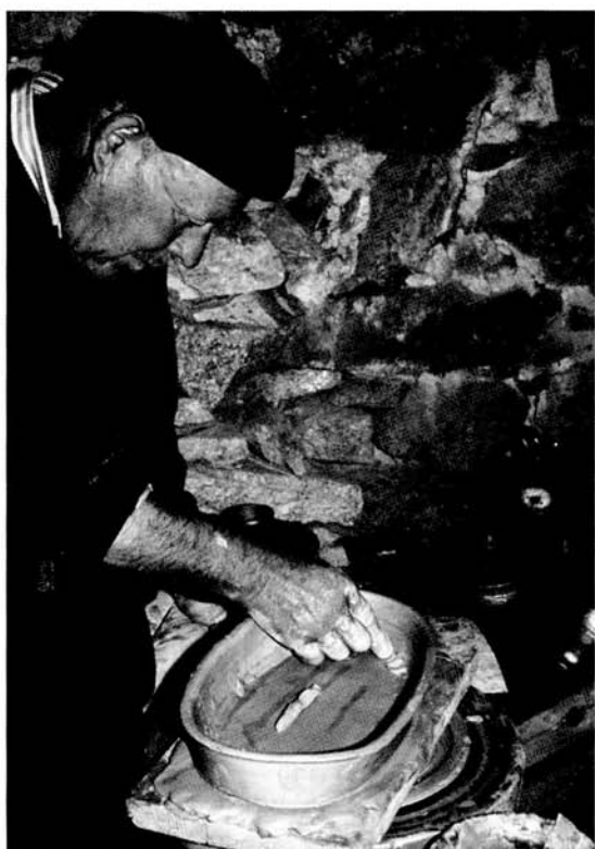
Figure 16 Luís da Silva : assemblage des deux parties par ajout de petits boudins (Cliché J. T.)
