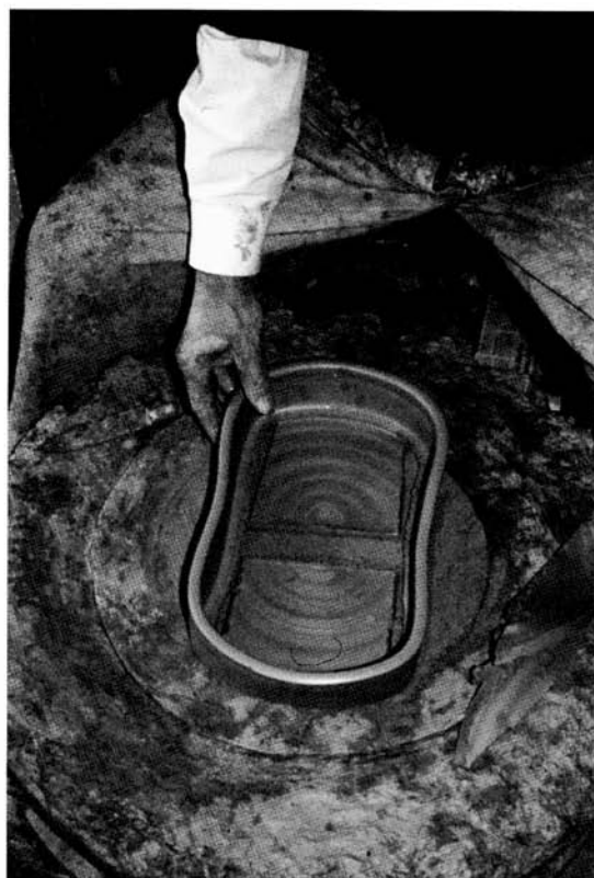
Figure 23 Après une découpe "K", Sezisnando Ramalho donne la forme à une pingadeira (Cliché J. T.)
