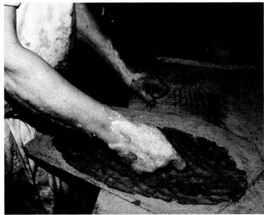
Figure 11 Arlindo Coelho da Silva de Vilar de Nantes prépare le fond. C'est généralement le travail de sa femme pendant qu'il tourne l'ébauche de la paroi. (Cliché J. T.)
