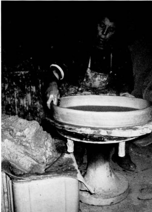
Figure 6 Le bord est mis en forme par pincement et lissage avec un chiffon humide par Alejandrina Pastor (Cliché M. Leenhardt)
