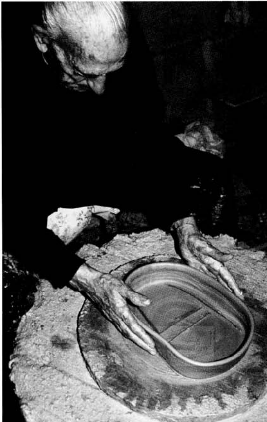
Figure 24 Après une découpe "D", Nascimento Capelas donne la forme à une pingadeira (Cliché J. T.)
