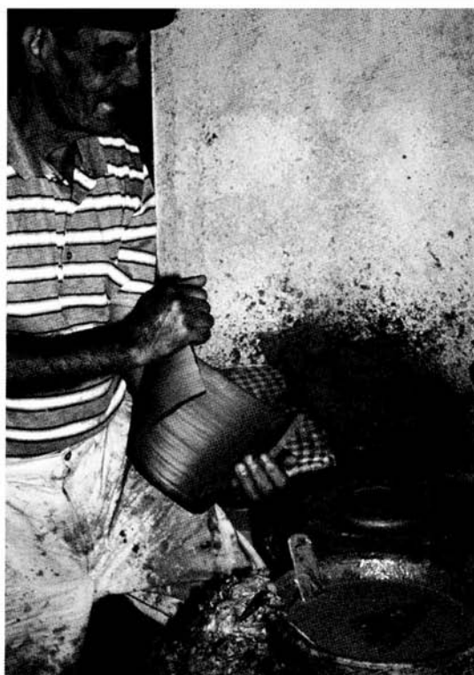
Figure 19 Daniel Ferreira : déploiement du fond après découpage de l'ébauche tournée (Cliché J. T.)
