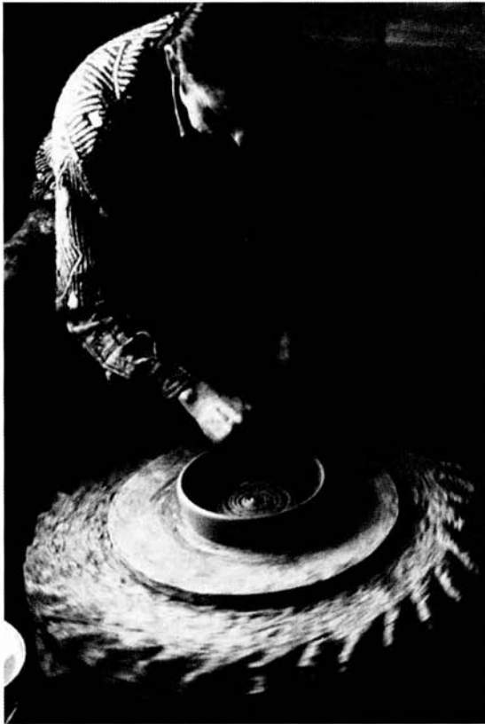
Figure 30 Lucílio Fernandes découpe le fond (découpe "B") pour une assadeira de barca (Cliché J. T.)
