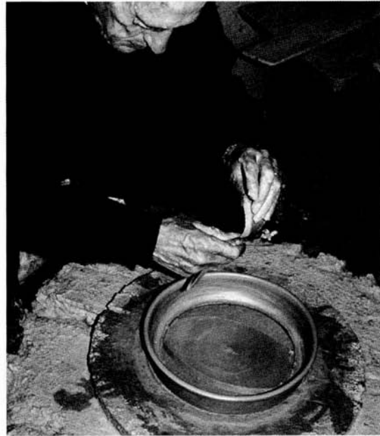
Figure 31 Nascimento Capelas enlève les croissants pour une assadeira de barca : découpe "C" (Cliché J. T.)
