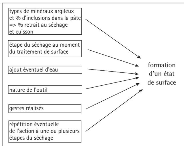
Fig. 2 – Paramètres influençant la formation d'un état de surface
