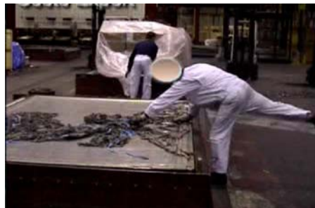
Figure 1 : Opérateur enlevant un filet (poids mouillé =20 Kg) en utilisant une posture simple : « UN BALANCIER ».
