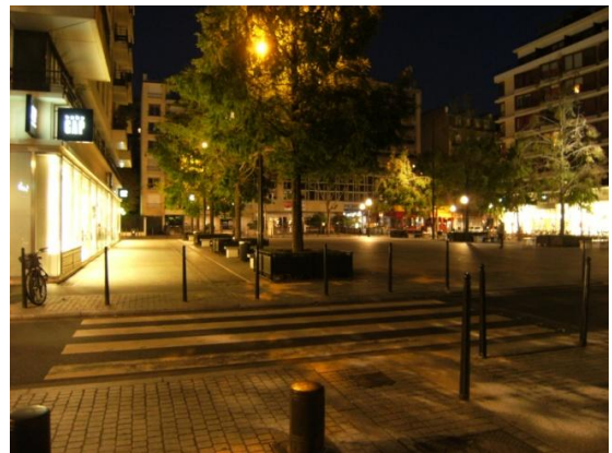
Figure 3 : l'essentiel de l'éclairage (50 lux) de cette partie de la place est assuré par l'éclairage des vitrines
