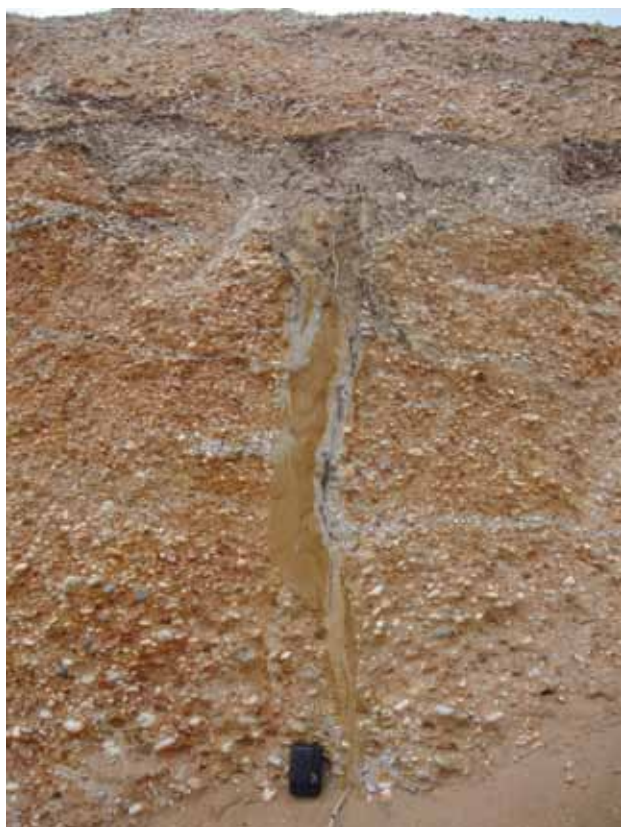
Figure 7 : Vue d'un coin sableux présent sur le front de carrière d'une exploitation de grave de la commune d'Arbanats. L'échelle est donnée par l'étui d'appareil photo long de 15 cm.
