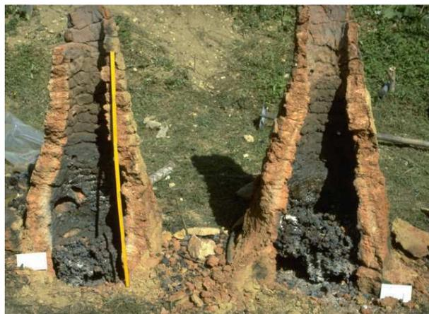
**Figure 25** : Etudes des traces sur deux fours expérimentaux après réduction de minerai de fer (Photo Ph. Andrieux)
