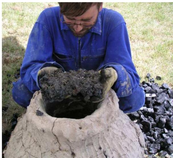
Figure 16 : Extraction d'une masse de fer résultant d'une réduction de chalcopryrite (Photo Ph. Andrieux)
