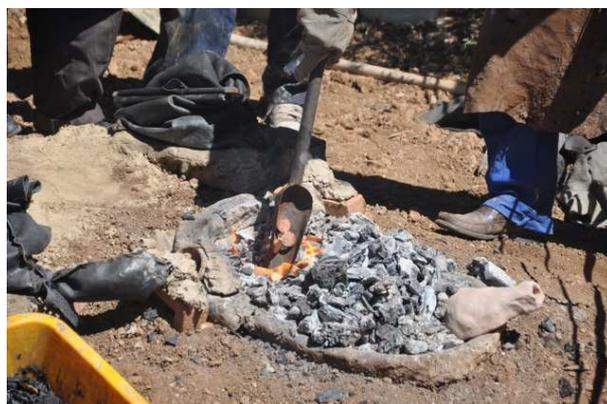
Figure 11 : Ajout d'étain et de cuivre dans le creuset pour réaliser un bronze (Photo B. Başaran)
