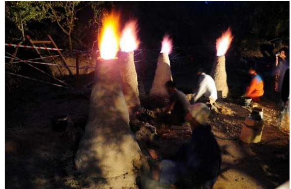
**Figure 14** : Quatre bas-fourneaux expérimentaux réalisés dans le cadre de Eski Anadolu'da Ateş Sanatları pour produire du fer (Photo B. Başaran)
