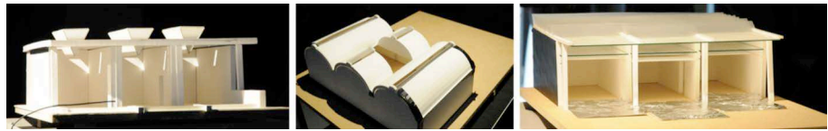
Figure 6. Comparaison des dispositifs de captage et transmission de la lumière du musée d'Aalborg, du musée Kimbell et de la fondation Beyeler
