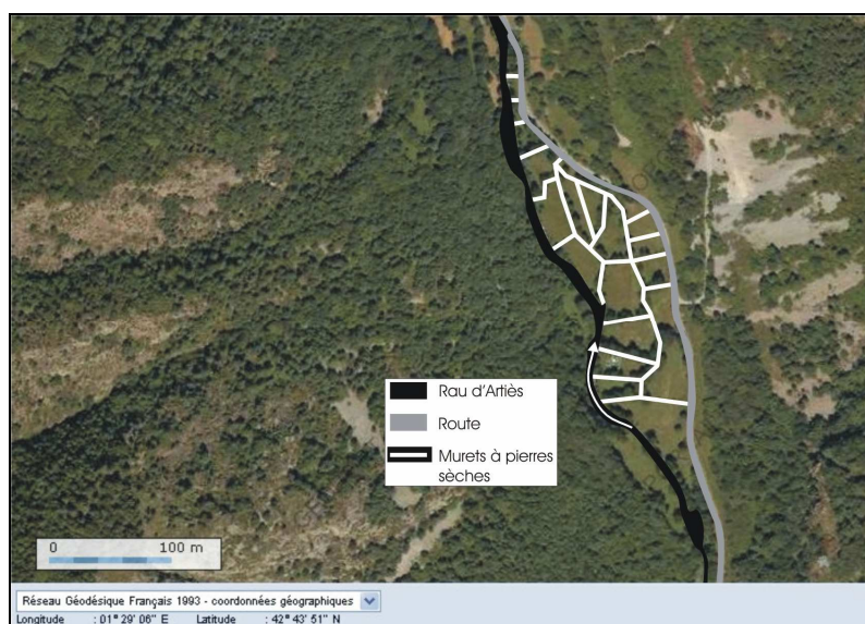
Figure 6 – Hameau d'Artiès, Auzat (Ariège) - Endiguement parallèle au torrent et protection en cascade des parcelles aval par les parcelles amont. (Source : IGN Géoportail)
