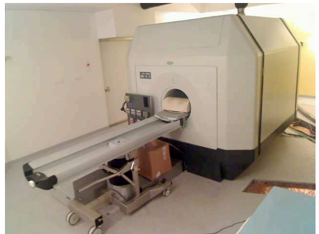
Figure 1 : Imageur Bruker Medspec 30/80 Avance - Aimant à haut champ (3 Tesla) du centre IRMf de l'Hôpital de la Timone à Marseille (photographie empruntée à J-L. Anton).
