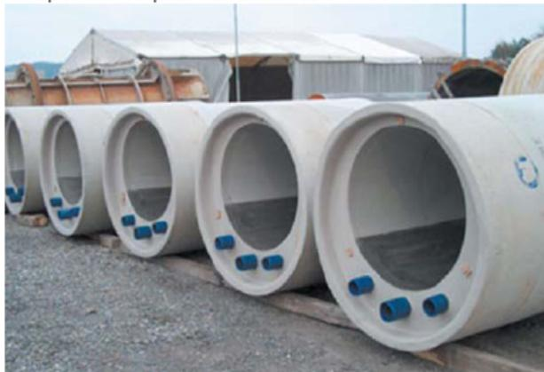
Photo 1 : Exemple de canalisations équipées d'échangeurs thermiques (source Saunier associés)
