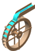
Fig. 8 - Roue motrice alimentée par-dessus avec coursier en bois
