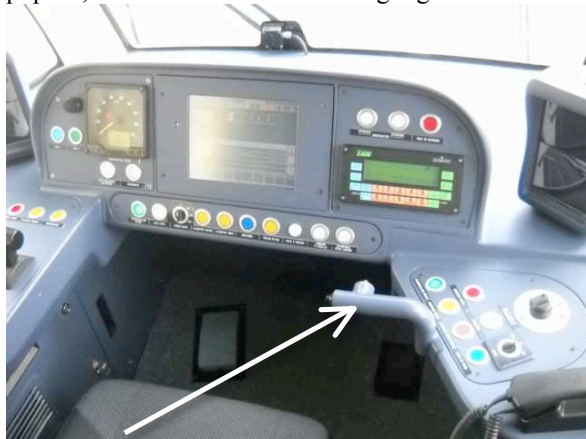
Photo n°2 : Poignée main droite avec gong. Photo AST25.
