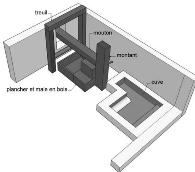
**Fig. 34** – Essai de restitution du pressoir d'époque julio-claudienne : variante de type B20 à montant unique (DAO : T. Debize).
